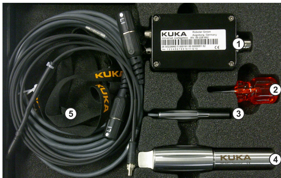
Fig. 5-7: Kit di calibrazione con SEMD e MEMD
