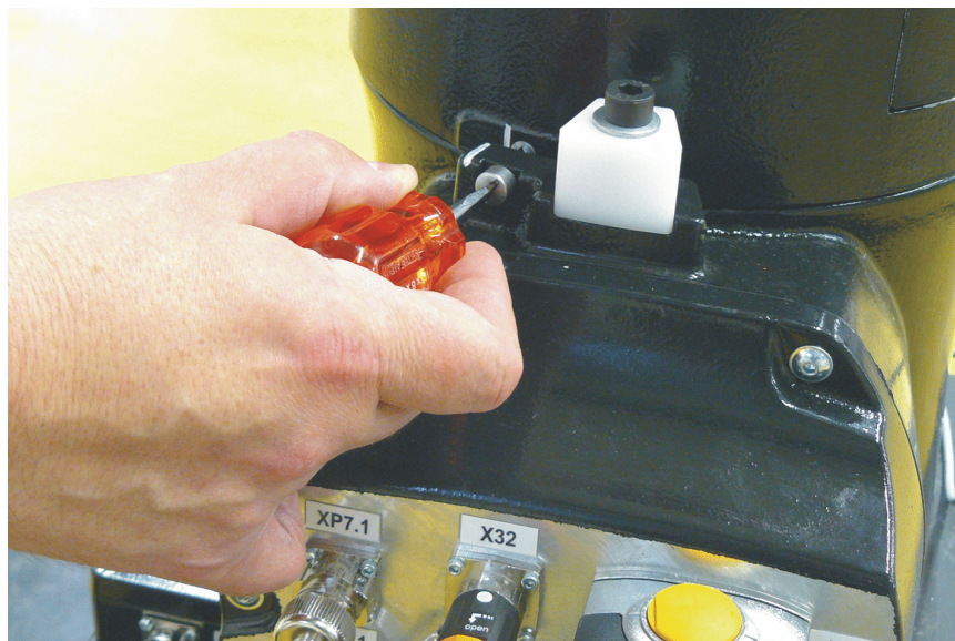
Fig. 5-21: Rimuovere la calotta di protezione della cartuccia di misurazione.
