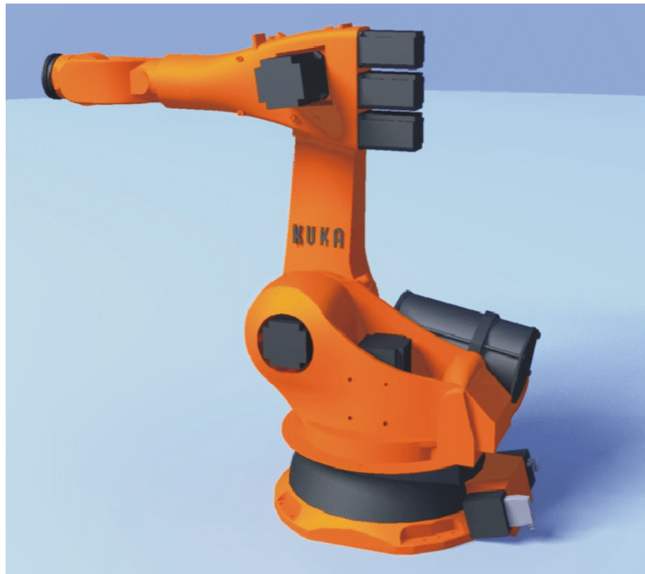
Fig. 5-6: Posizione di calibrazione - posizione approssimativa
