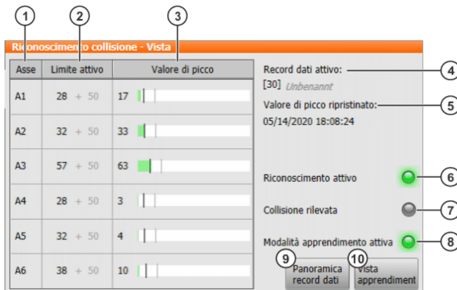
Fig. 7-24: Riconoscimento collisione - Vista (funzionamento programma e modalità di apprendimento)
