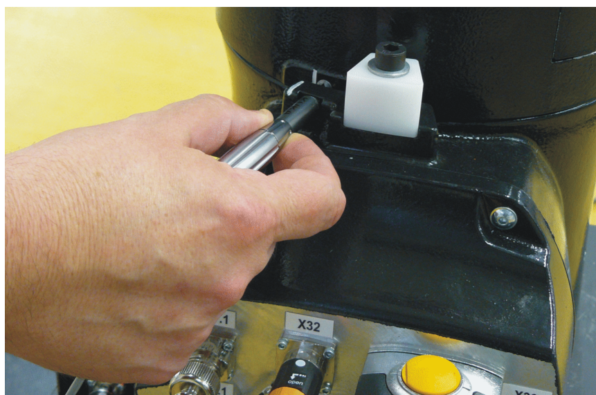
Fig. 5-22: Avvitamento di MEMD sulla cartuccia di misurazione
